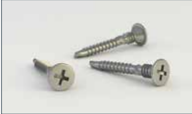
Vis inox pour ossature à bois SCR-W 3,9 x 38 mm PH2, Zytex GX Pour système de montage avec fixations invisibles sur ossature bois. Egalement disponible pour visseuse à cartouche
